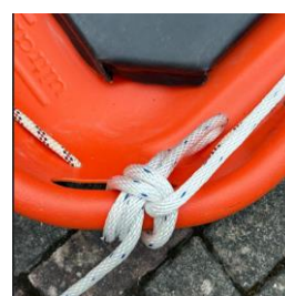
Bild 3. Befestigen der Schleifkorbtrage an der Steckleiter mit Mastwurf und Spierenstich als Sicherungsknoten.
