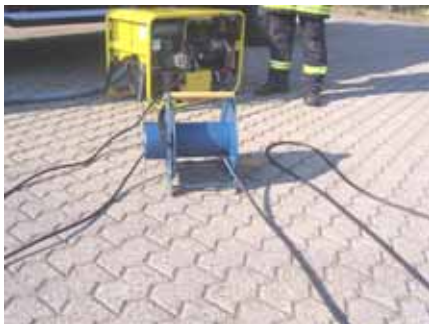
Bild 6: Vollständiges Abrollen des Kabels vermeidet Überhitzung während des Betriebes.
