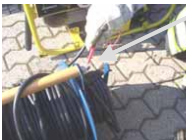
Bild 7, 8 und 9: Schutzleiterprüfung an Kabeltrommel ..... Schuko-Dreifach-Kupplung .....Flutlichtstrahlern.
