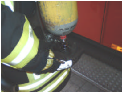
Bild 6: Das Flaschenventil öffnen und wieder schließen.
