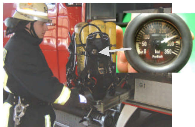
Bild 1: Bei einem 300-bar-Gerät ist mind. 270 bar Fülldruck nötig.
