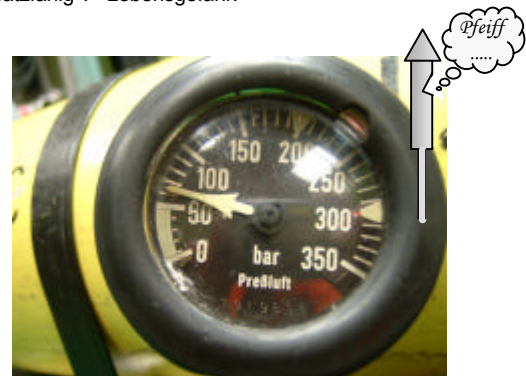
Bild 10: Der Restdruckwarner ertönt bei 55 bar ± 5 bar.
