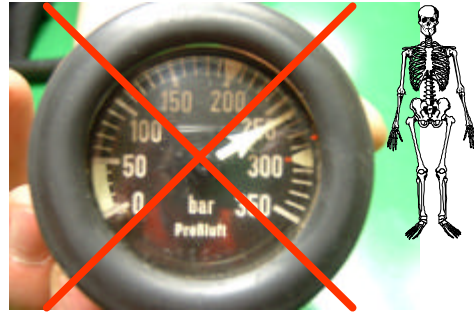
Bild 2: Lebensgefahr ? das 300-bar-Gerät hat weniger als 270 bar Flaschendruck!
